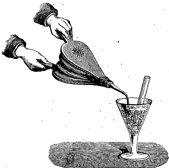
Fig. 87. — Congélation de l'eau par l'évaporation de l'éther.
